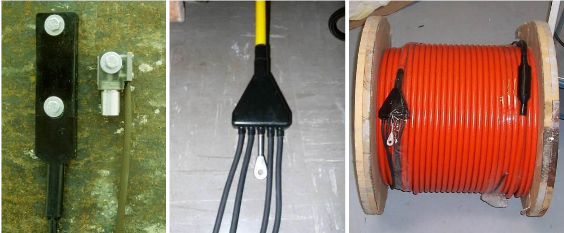
Abbildung 4: Dehnungs- und Beschleunigungssensoren (links) für Messung bis in große Wassertiefen, Verbindung zum Hauptmesskabel mit Zugsicherung (Mitte), nach erforderlicher Länge konfigurierbares Messkabel von den Sensoren am Pfahl zur Messstation (rechts)
