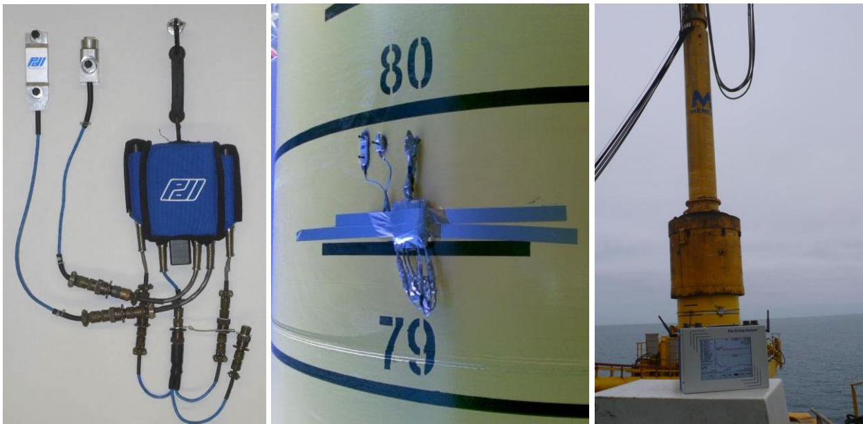
Abbildung 1: Sensoren und Sendeeinheit (links und Mitte), Messgerät mit Empfängereinheit und Sensoren am Pfahl während des Monitoring der „Überwasser“-Rammung im OWP Bard Offshore 1 (rechts)
